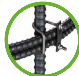
FJ タイプ 従来型帯鉄筋重ね継手用 従来型帯鉄筋の重ね継手部と主鉄筋 と一緒に固定することでより高い強度を 確保します。 ※従来型帯鉄筋1本あたり、重ね継手部 2ヶ所使用。
