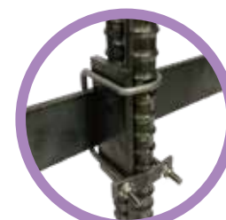
TAWタイプ 鉄筋+鉄筋+ねじれ防止補強筋 × 補強棒 (FB) 鉄筋側でネジ締める。 補強棒 (FB) を適宜使用し、ねじれ防止 補強筋を用いることで鉄筋かこのねじれ 強度を高め、座屈・変形を防ぎます。 ※円周に4ヶ所程度使用。
