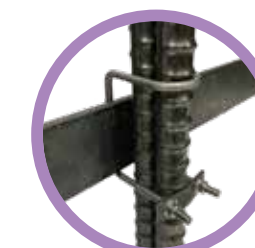
TA タイプ 鉄筋+鉄筋×補強棒 (FB) 固定用 鉄筋側でネジ締める。 鉄筋 (束ね筋) と補強棒を固定する金具。 補強棒の周囲、TAW以外全ての鉄筋に 使用する。
