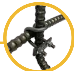
SF/FI タイプ 井桁筋固定用 井桁筋を高い精度で固定すること により脱落防止の効果が高まります。 ・SFを主鉄筋と帯鉄筋に4ヶ所程度使用 ・FIを帯鉄筋と井桁筋に4ヶ所程度使用
