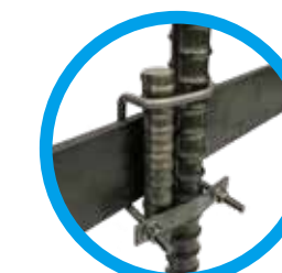
AW タイプ 主鉄筋+ねじれ防止補強筋 × 補強棒 (FB) 主鉄筋側でネジ締める。 補強棒 (FB) を適宜使用し、ねじれ防止 補強筋を用いることで鉄筋かこのねじれ 強度を高め、座屈・変形を防ぎます。 ※円周に4ヶ所程度使用。
