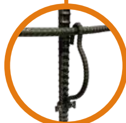
スペーサー スペーサー本体とプレートを溶接固定 しているので作業効率が向上します。 ※Uボルトで主鉄筋と固定。 スペーサーの高さは80mmと60mmの 2種類
