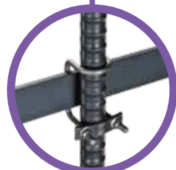
A タイプ 主鉄筋 × 補強棒 (FB) 固定用 主鉄筋側でネジ締める。 GT工法では工具の入りにくい円筒の 下側に使用することが多い。
