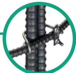
SJ タイプ 主鉄筋重ね継手用 主鉄筋の重ね継手部と帯鉄筋を束 ねることによって、スレをなくし強度を 高めます。 ※主鉄筋の重ね継手部1本につき上下 2ヶ所、1本とVに使用することを推奨。
