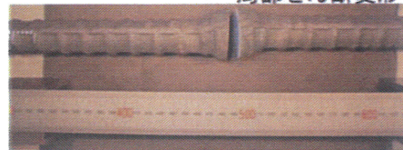
引張軸に垂直に破断
