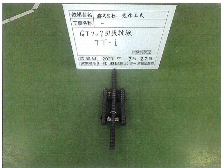
写真-1 試験前の状況
