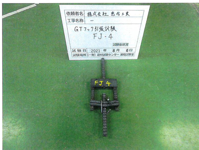
写真-3 試験後の状況
