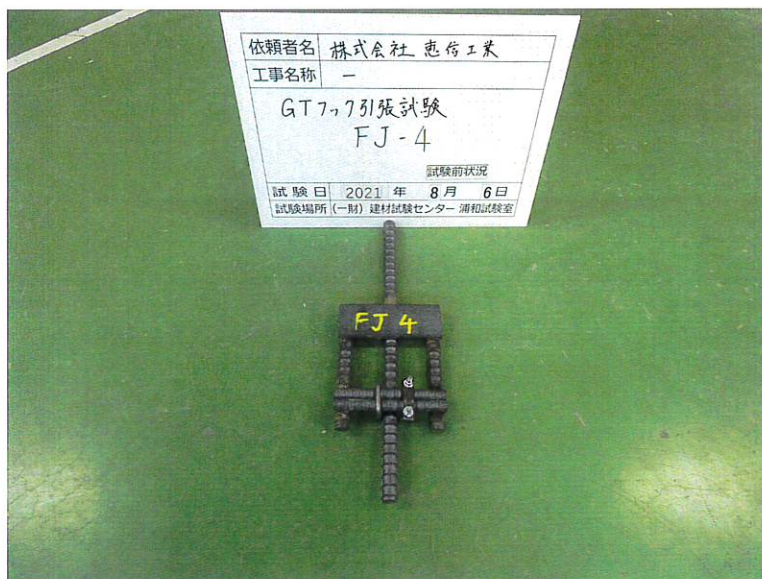
写真-1 試験前の状況
