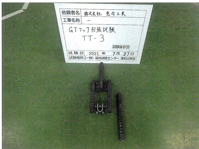
写真-3 試験後の状況
