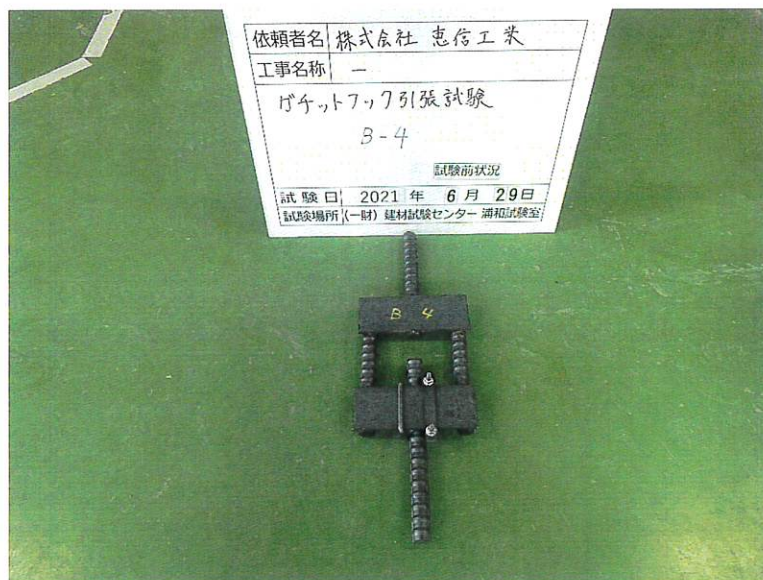
写真-1 試験前の状況
