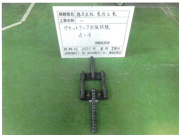
写真-3 試験後の状況
