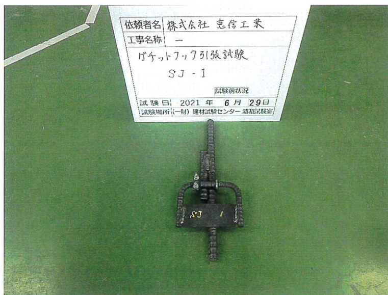
写真-1 試験前の状況
