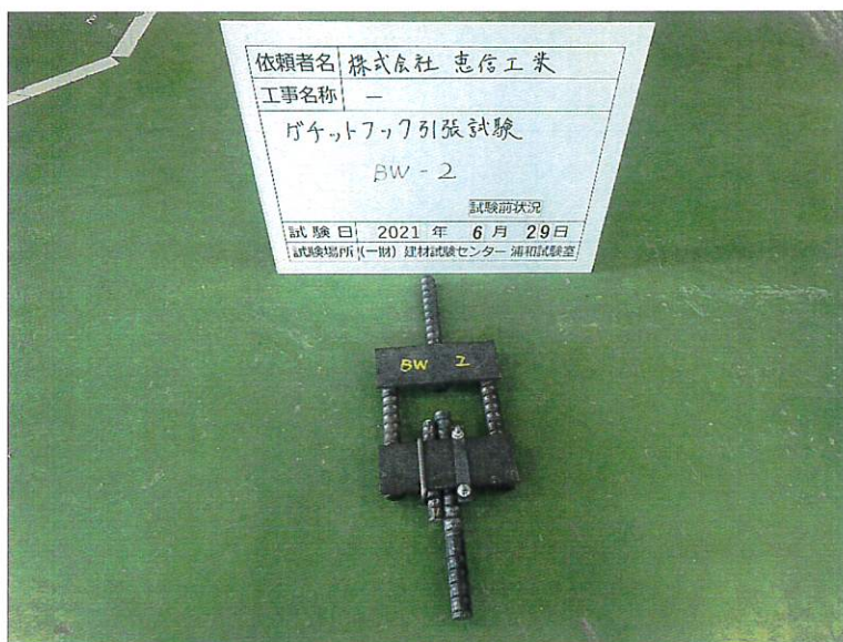
写真-1 試験前の状況
